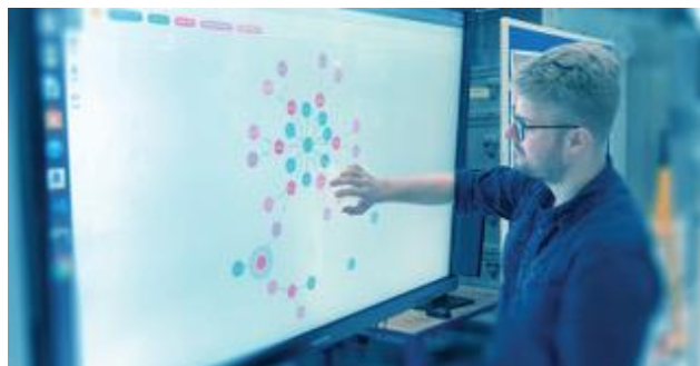
Abbildung einer Werkstattumgebung als vernetztes Datenmodell. Mit Hilfe einer graphischen Datenbank wird jede Entität (beispielsweise Mensch und Roboter) dargestellt und verknüpft. © Synergeticon
